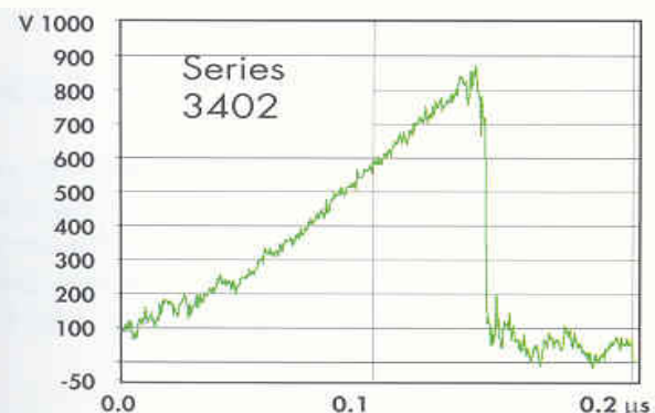
Impulso residuo scaricatore serie 3402 con capsula di 230 Volt della Suhner .
